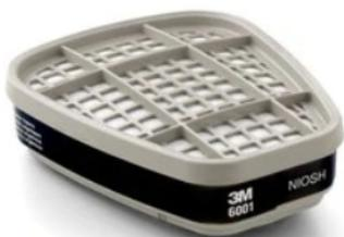
O cartucho pode ser utilizado para concentrações de vapor de até 10 vezes o limite de exposição permissível (PEL) usando-se peças semifaciais, ou até 100 vezes o PEL quando se usa peças faciais inteiras com testes quantitativos de ajuste.
