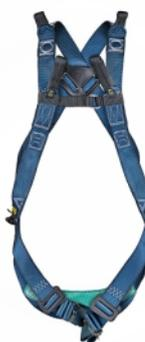
Cinto paraquedista com 3 pontos de conexão. Ponto de conexão dorsal (em argola de aço) – Proteção contra quedas; Ponto de conexão peitoral (em alças de poliéster) – Proteção contra quedas; Ponto de conexão nos ombros – Movimentação e espaço confinado; 2 ajustes nas pernas; Fivelas duplas de aço com pintura epóxi
