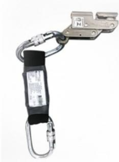
Trava-quedas guiado em linha rígida para cabo de aço de 8mm, como por exemplo, em escada fixa (marinheiro) ou acessos permanentes. Equipamento desenvolvido para limitar quedas através de um sistema de travas, acionado de acordo com a movimentação do olhal C0801. Possui absorvedor de impacto, com 2 conectores classe B, em aço com abertura de 15mm.
