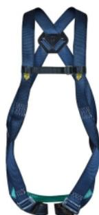
Cinto Paraquedista HL009 totalmente ajustável, em poliéster, com ponto de conexão dorsal. Desenvolvido para oferecer excelência no trabalho e segurança nos mais diversos níveis de periculosidade. Possui 2 ajustes nas pernas e no peitoral, fivelas duplas de aço com pintura epóxi. Com alças laterais para descanso do Talabarte e proteção sub-pélvica. Possui indicador de impacto.
