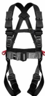
Cinto Paraquedista HL01203M totalmente ajustável com ponto de conexão dorsal. Pode ser utilizado com talabarte, trava-quebras de corda / cabo e trava-quebras retrátil, garantindo ainda mais conforto e segurança. Confeccionado em poliéster com fivelas duplas de aço com pintura epóxi. Possui 1 ajuste na cintura, 2 ajustes nas pernas e 2 ajustes nos suspensórios.
