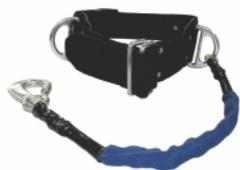
Cinto Abdominal HL001B4 Cinturão confeccionado em fita de algodão e poliéster preta com 80 mm de largura. utilizado somente para posicionamento. Possui um talabarte em poliamida para posicionamento (talabarte acoplado ao cinturão), com um conector classe T em alumínio com abertura de 20 mm, com protetor removível em tecido para-aramida com fechamento em ganchos e argolas.
