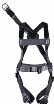
Cinto Paraquedista HL00201 totalmente ajustável com ponto de conexão dorsal e extensor. Específico para uso com trava-quebras retrátil, garantindo ainda mais conforto e segurança. Confeccionado em poliéster com fivelas duplas de aço com pintura epóxi. Possui 1 ajuste na cintura e 2 ajustes nas pernas. Extensor em poliéster com meia argola de aço. Conta com fechamento peitoral em velcro e passador tipo clipe para armazenamento da sobra de fita. Possui proteção nas fivelas de ajuste.
